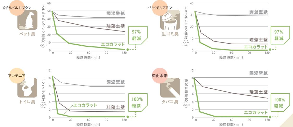
※ 試験結果は当社試験によるものです。部屋の使用条件、気象・換気などの環境条件によって異なります。
