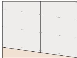
壁紙・下地材の確認。壁紙の上にステンレスステープルでタッカー打ち。
