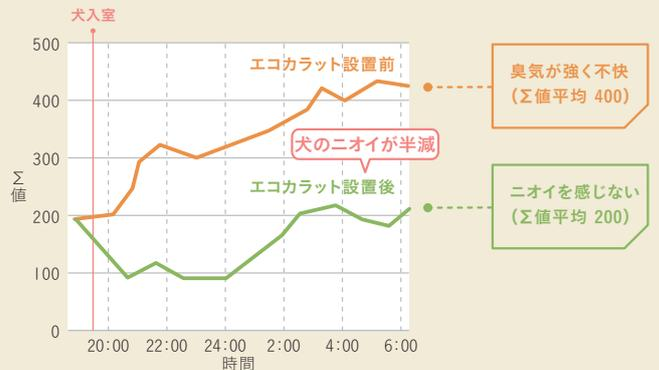
※ 実際の住居にてペット臭がエコカラットの設置前後でどのように変化したかを測定。
