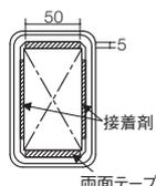
エコカラット張り完了後、スペーサー表面の両面テープを併用し、接着剤で張り付けます。接着剤はスーパーエコぬるを使用し、長辺側に塗布してください。
