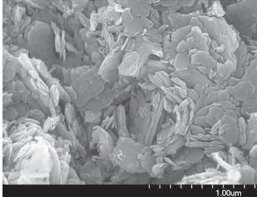
これは、粘土鉱物などの微細な孔を持つ原料をタイル状に焼いてインテリアで使用できるようにしたものです。この微細な1ナノメートル（1mmの百万分の1）の孔に空気中の湿気が入ったり出たりすることで、湿気を吸収したり放出したりして湿度を変化させる働きをしていると考えられています。
